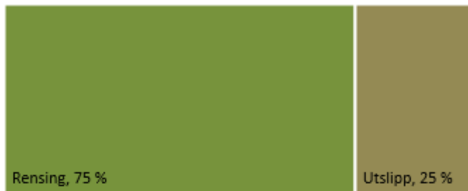
Figur 42 Forventet organisk stoff i spillvann BOF 5 /år i Kristiansand, etter ombygging av Odderøya RA.
